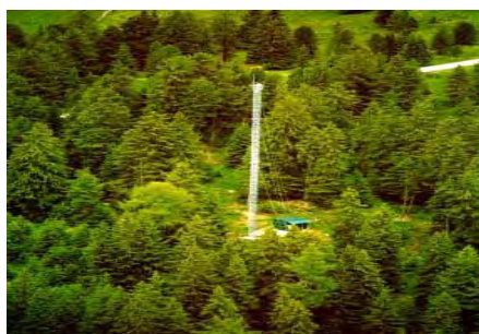
Fig.3.2.2. La stazione di misurazione eddy covariance permette di rilevare il "respiro del bosco" cioè lo scambio gassoso di CO 2 e vapore acqueo tra atmosfera ed ecosistema forestale. (fonte Prov. Aut. di Bolzano – Ripartizione Foreste).
