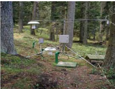
Fig. 3. Stazione meteo "in the plot" – Lisimetri a gravità a differenti profondità.
