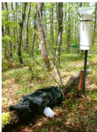
Fig. 5.1.1. Collettore per le deposizioni atmosferiche e trappola per insetti nel bosco di Monte Rufeno (Acquapendente, VT).
