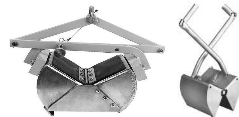
Fig. 88. Draga per la raccolta di bentos profondo. A sinistra aperta, a destra in chiusura.
