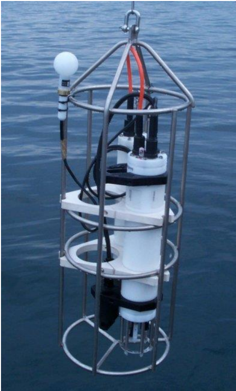
Fig. 90. Sonda multiparametrica Ocean 316 (Idronaut, Brugherio). Il cilindro di fronte contiene l'elettronica di misura e, alla sua base, sono visibili i diversi sensori. Al bordo superiore del castello contenente la sonda è fissato un sensore sferico per la misura della radiazione subacquea (PAR).
