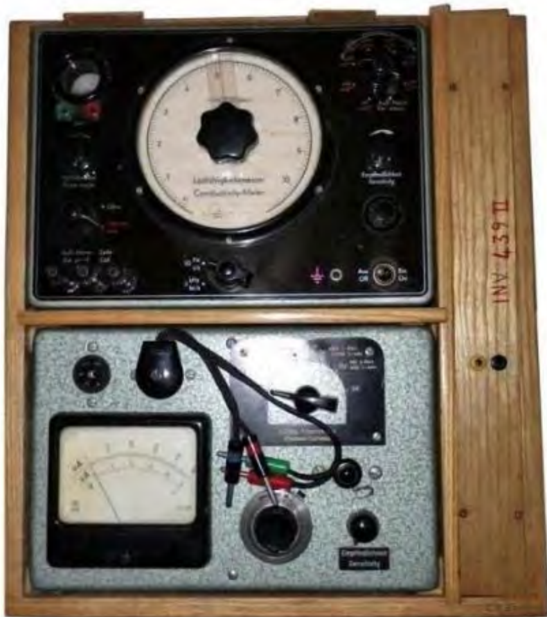
Water conductivity meter, Kohlrausch bridge (WTW, Wissenschaftlich-Technische Werkstätten GmbH). 1962.
